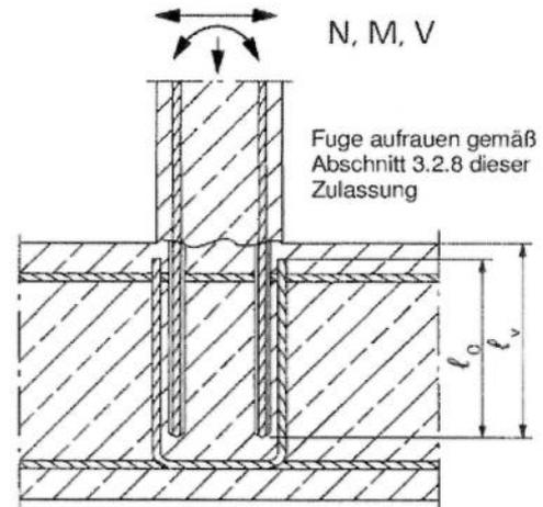
**Bild 3:** Endverankerung von Platten oder Balken
