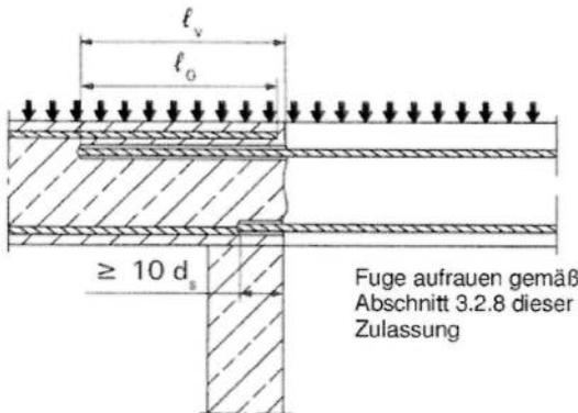
**Bild 2:** Übergreifungsstoß einer biegebeanspruchten Stütze oder Wand an ein Fundament
